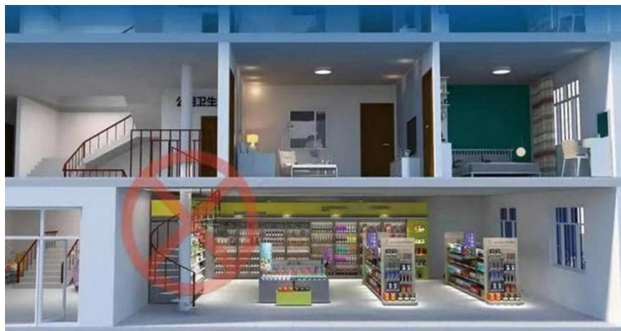
图例 6：经营性自建房的住宿部分与生产、经营区域未完全防火分隔。
