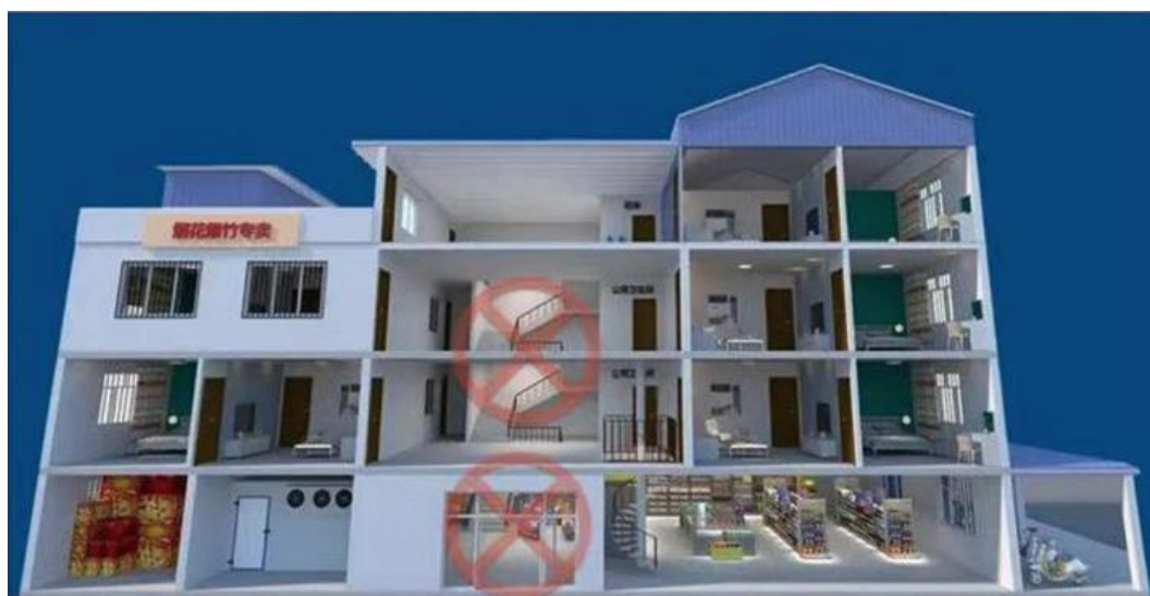
图例 9：“下店上宅”住宿部分未设置独立疏散楼梯
