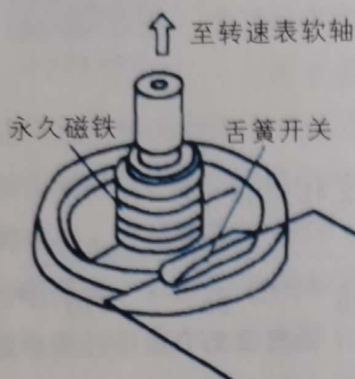
图 2-2-58 舌簧开关型车速传感器
