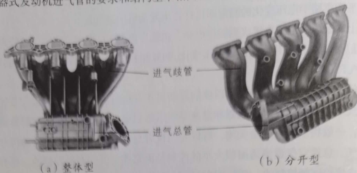
图 2-2-32 进气管的结构
