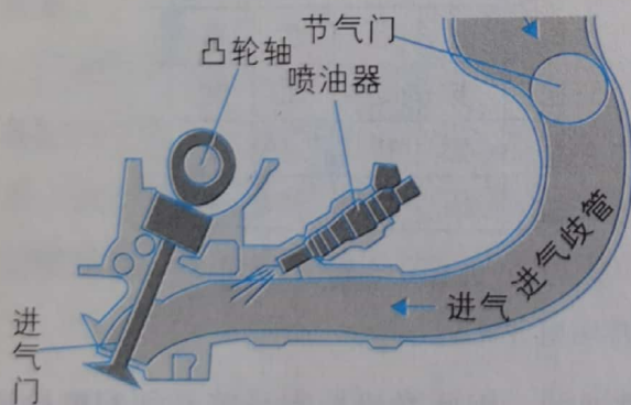
图 2-2-6 进气管喷射式
