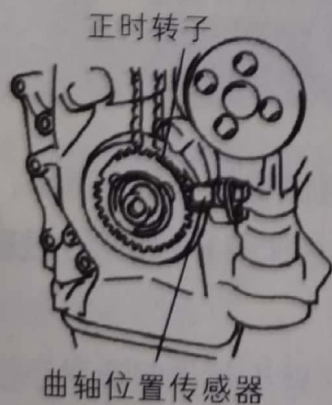
图 2-2-37 曲轴位置传感器安装位置
