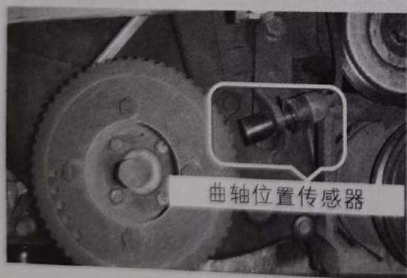
图 2-2-33 曲轴位置传感器的安装位置
