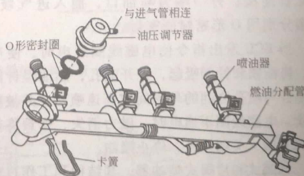
图 4-97 燃油分配管的结构
