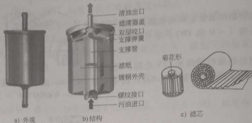
图 4-94 汽油滤清器的结构
