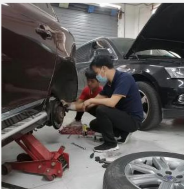
图 3-14 企业技师开展制动系统维修技术实训教学
